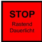
Beim Drücken des **Stopp** Schalters wird der normale Check-In Vorgang unterbrochen. Solange der **Stopp** Schalter betätigt ist, wird kein Gepäck auf das Sammelband geschleust!
